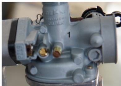
1. Parafuso de ajuste de rotação em neutro
